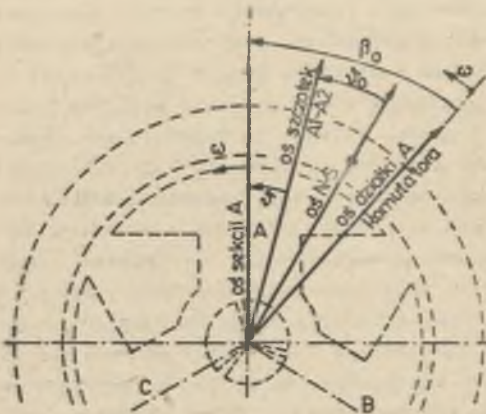
Rys. 2. Oznaczenie osi charakterystycznych w silniku oraz kątów \alpha_0 , \beta_0 , \gamma_0 . Przesunięcia kątowe zgodne ze strzałkami uważa się za dodatnie
