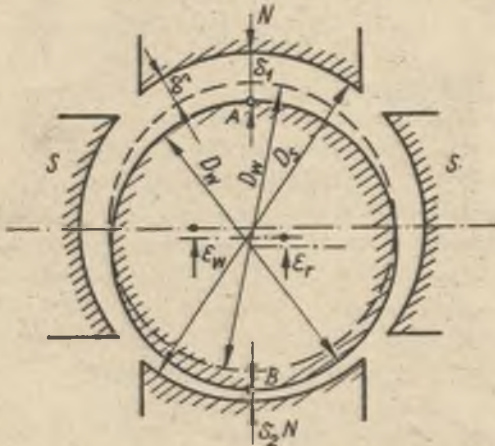
Rys. 5. Zmienność szczeliny powietrznej przy mimośrodkowości złożonej
